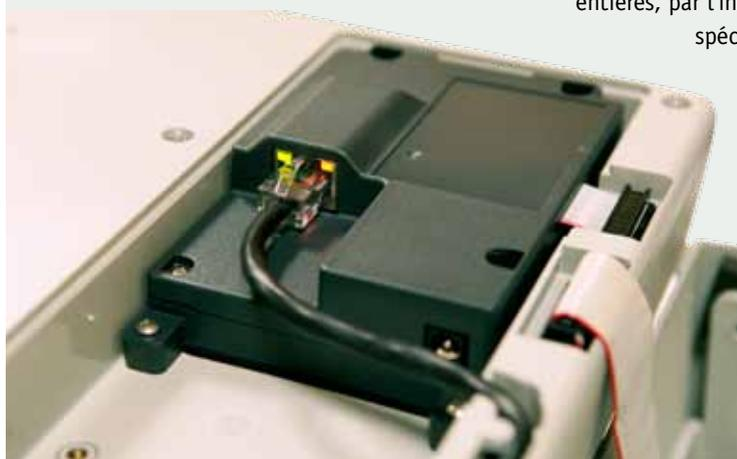
ACC-COM-LAN : équipé d'une prise jack réseau standard à l'arrière pour une connexion facile au réseau informatique des clients.
