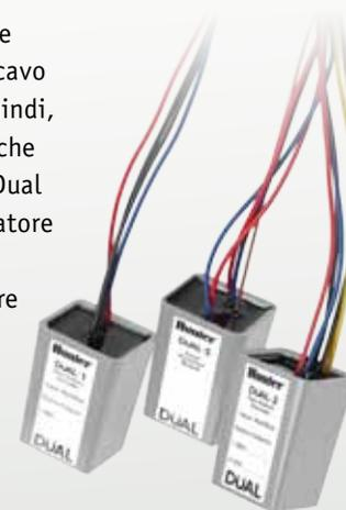
I decodificatori presentano un costo realmente competitivo e non includono il cavo di messa a terra. Tuttavia, tale protezione viene fornita dai moduli di soppressione di sovratensione Dual-S, che sono installati nei percorsi monocavo e messi a terra come necessario (minimo, dopo ogni 12° decodificatore o a distanza di 300 m).
