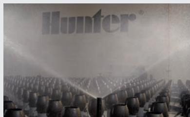
Gli irrigatori vengono sottoposti a scrupolosi test nel laboratorio di analisi delle precipitazioni.
