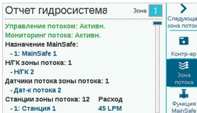
Режим отображения информации можно изменить с помощью функциональных кнопок Controller («Контроллер»), Flow Zone («Зона расхода») и MainSafe (если это применимо).
