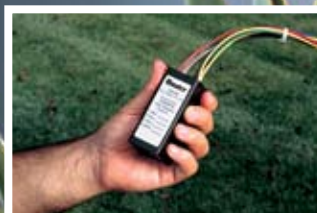
Decodificatori programmabili sul campo, con dispositivo di protezione contro sovratensioni
