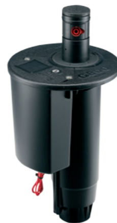
G870C 弹出高度: 8 cm 整体高度: 30 cm 法兰直径: 18 cm 内螺纹进口: 1½" ACME
