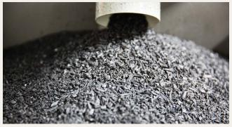
Plastique ABS Les produits fabriqués en plastique noir ABS contiennent jusqu'à 13 % de matériaux recyclés.
