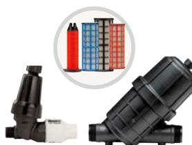
Tutti i filtri Hunter hanno uno schermo in acciaio inossidabile e una ridotta perdita di carico. I filtri da 1½" e 2" sono disponibili con dimensioni di 80 mesh (180 micron), 120 mesh (125 micron) e 150 mesh (100 micron) con un filtro a dischi da 120 mesh (125 micron).
