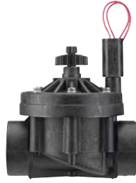
محبس ICV-201G قطر المدخل: 2 بوصة (50 مم) الارتفاع: 18 سم الطول: 17 سم العرض: 14 سم
