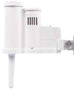
جهاز الاستشعار Rain-Clik اللاسلكي (مع ذراع تركيب) الارتفاع: 7.6 سم الطول: 20 سم العرض: 2.5 سم
