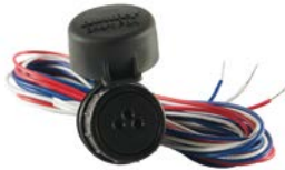
مجموعة التوصيلات السلكية SmartPort يتطلب استخدام أجهزة التحكم عن بعد من Hunter تركيب مجموعة التوصيلات السلكية SmartPort التي يتم توصيلها بأطراف التوصيل بوحدة التحكم وتتيح الاتصال السريع بأي جهاز استقبال من Hunter.
